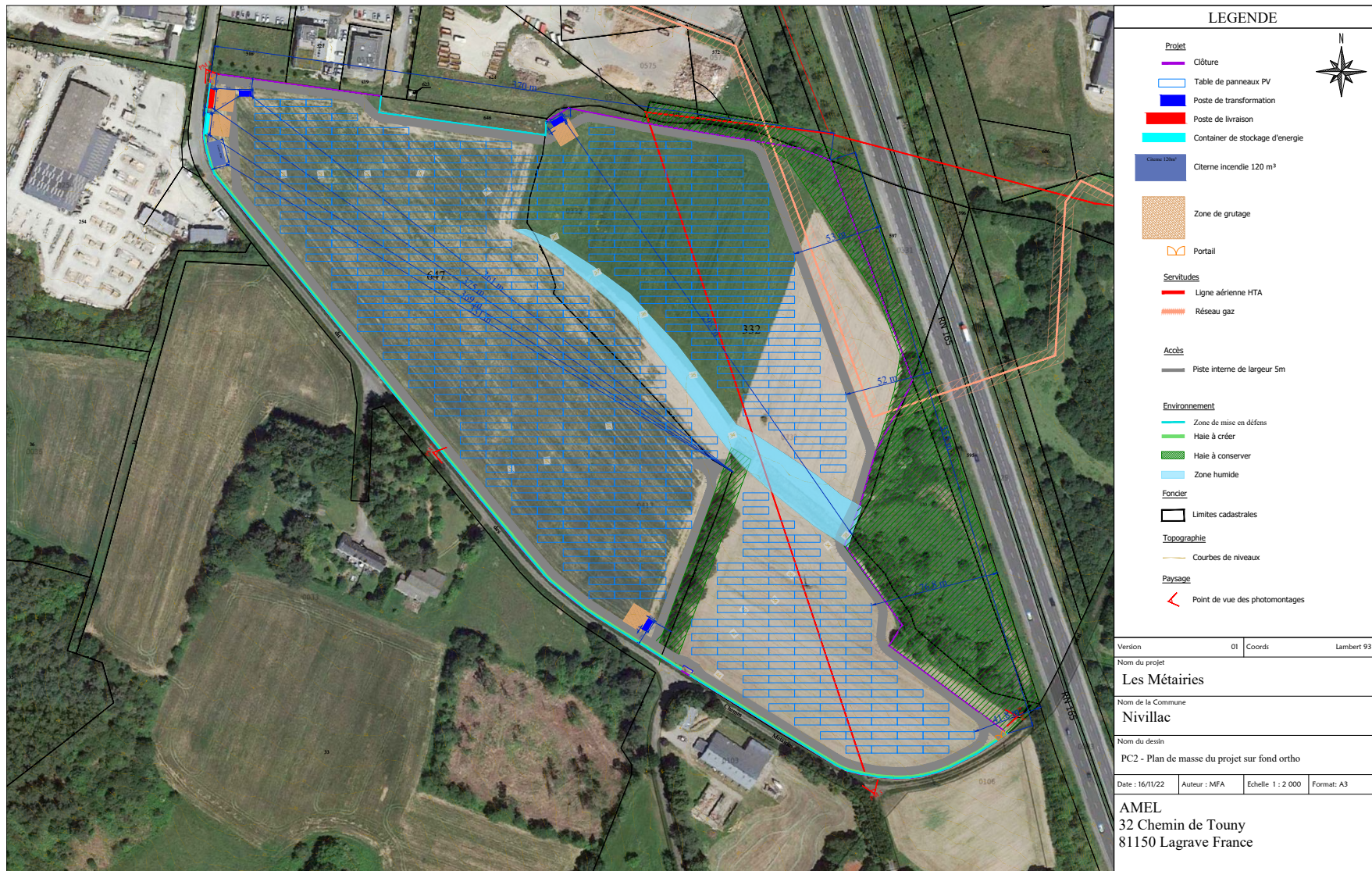
Figure 53 : Plan d'implantation du projet photovoltaïque (Source : AMEL)
